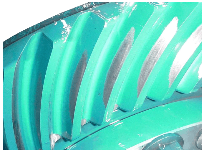
Tragbildkontrolle eines Kegelrads
